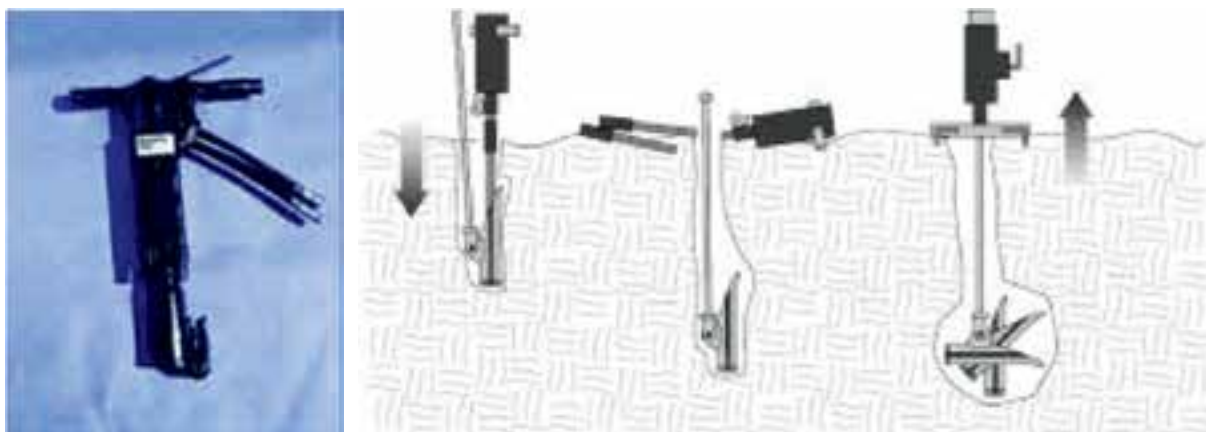
Slika 1.76. Hidraulični čekić i princip upucavanja sidra u dno
